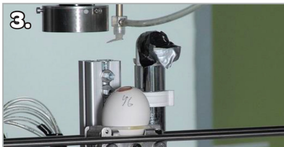
3. Så løftes biten av skallet vekk. 4. Før kjønnnet blir bestemt ved hjelp av spektroskopisk optikk, der en ved hjelp av en laser kan lese av raman-spekteret i det enkelte egg.
