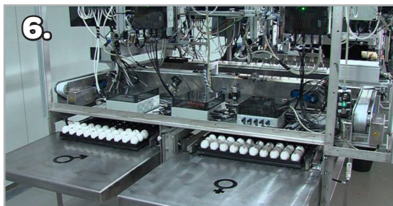
5. Etterpå må hullet i skallet tettes med et «plaster». 6. Til slutt blir eggene sortert i forhold til kjønn. Eggene med høner går tilbake til videre ruging, mens eggene med hanner blir tatt og levert til industriell bruk.
