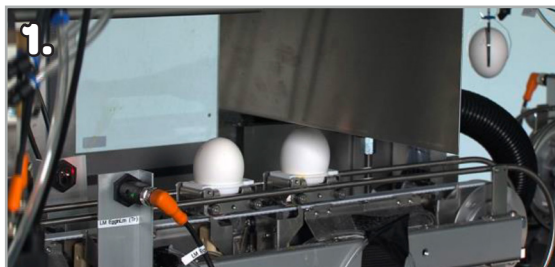
1. Først må det lokaliseres nøyaktig hvor luftblommen er i hvert enkelt egg. 2. Neste trinn er å skjære ut en bit av skallet med CO 2 -laser. Dette gjøres der luftblommen ligger, slik at en ikke kommer i berøring med den indre skallhinnen.
